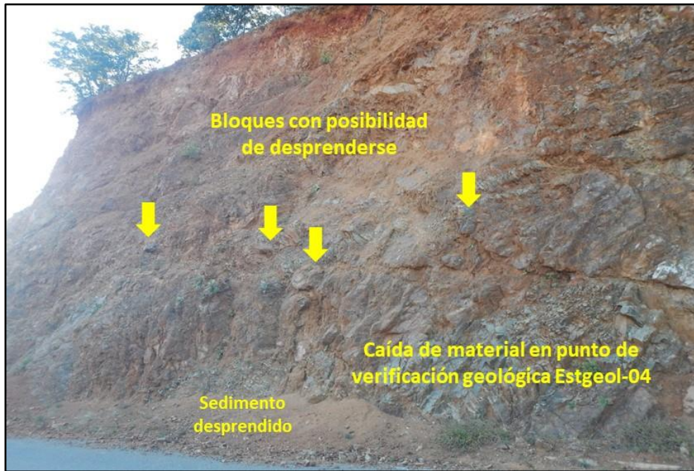
Fotografía 2.22. Características estructurales observadas en el sitio de Control Geológico-Estructural Estgeol-04 donde se tiene el afloramiento de rocas metamórficas del tipo gneiss.
