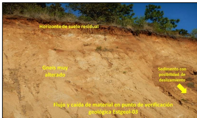
Fotografía 2.19. Sitio de Control Geológico-Estructural Estgeol-03 ubicado en las inmediaciones de San Pedro Coatlán.
