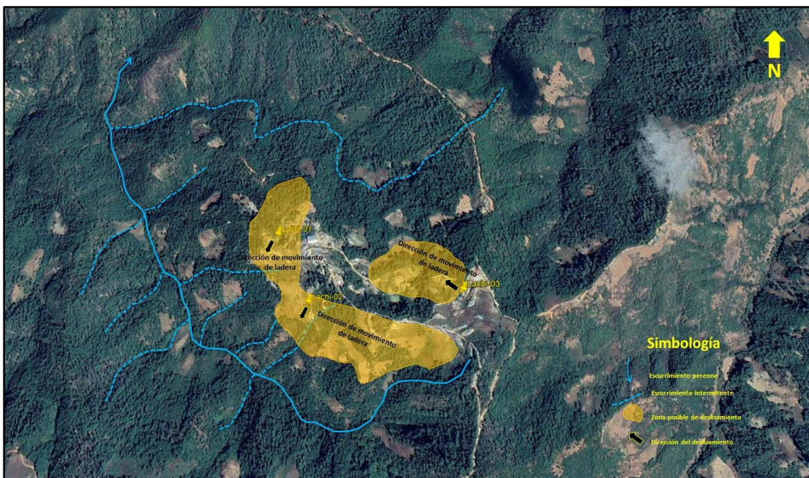
Figura 2.11. Ubicación de zonas con posibilidad de deslizamiento y dirección de deslizamiento en la Agencia Municipal Sitio Lachidoblas.
