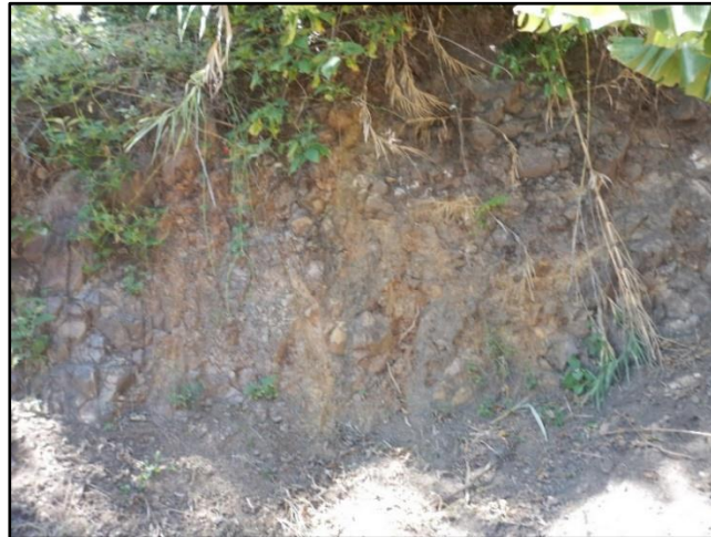
Fotografía 2.72. Material del tipo aluvial fracturado y poco consolidado con posibilidad de deslizamiento
