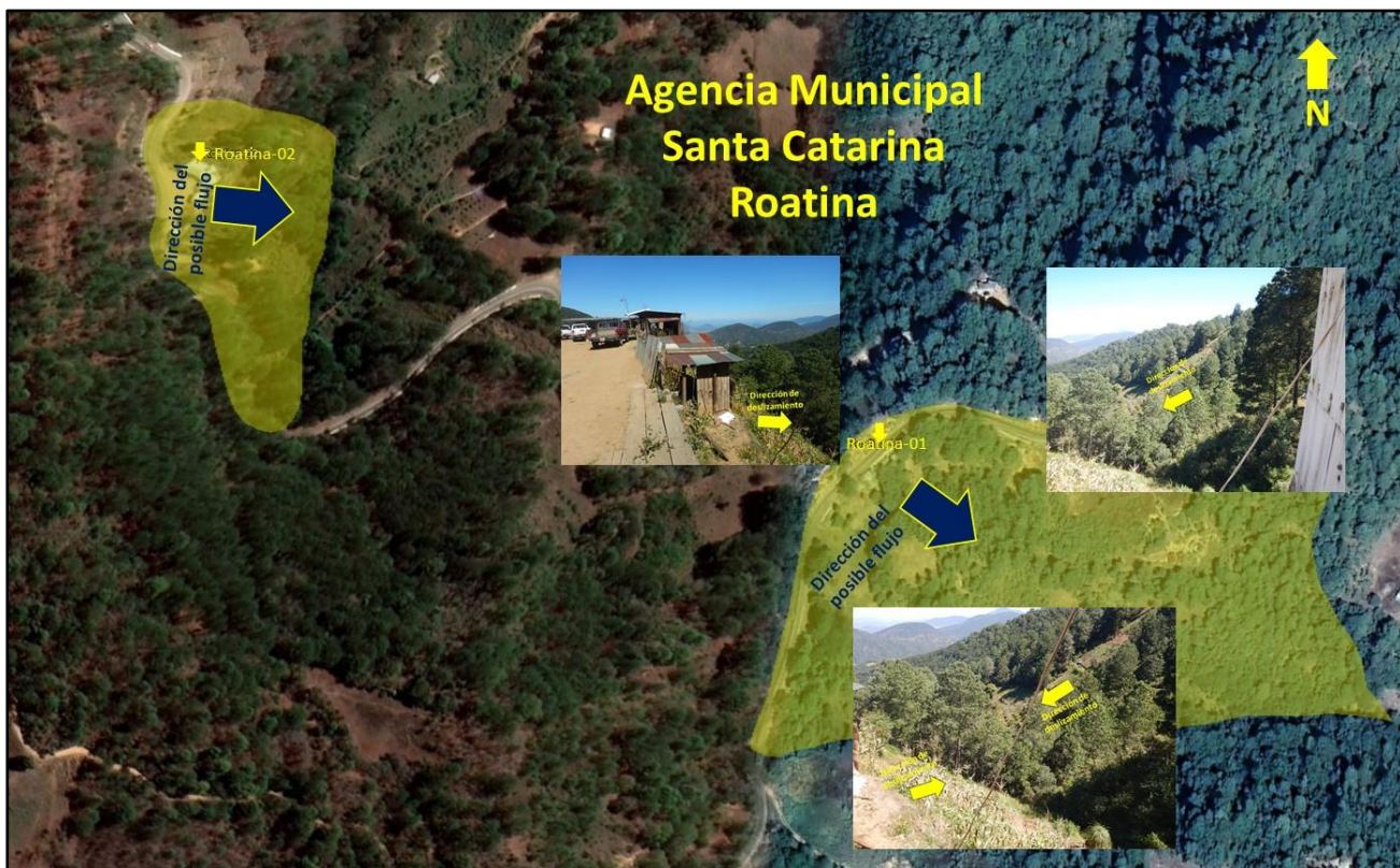
Figura 2.13. Ubicación de zonas con posibilidad de deslizamiento en la Agencia Municipal Santa Catarina Roatina.
